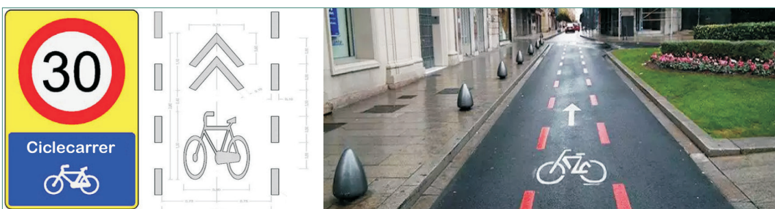
Imagen 57.- Ciclocarrer i senyalització horitzontal i vertical.
