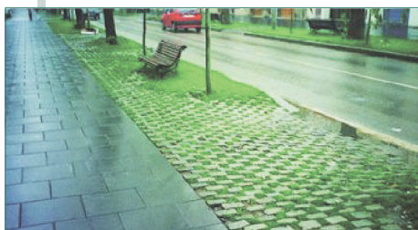
Imatge 1. Separació de les franges per a la circulació dels vianants i per al mobiliari urbà.
